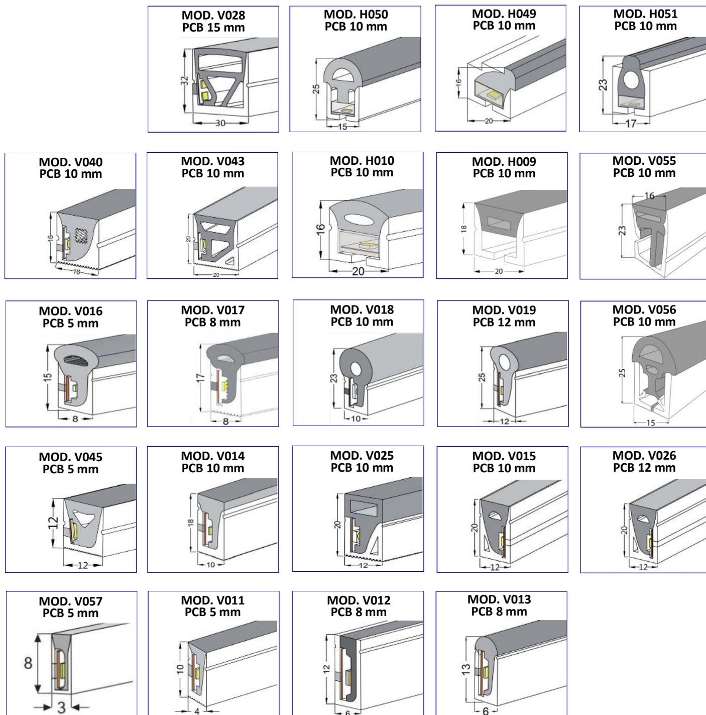
Le nostre **Neon Rope Led**, in funzione delle scelte del Cliente, vengono preparate su misura dal nostro reparto di produzione e saranno consegnate, della lunghezza desiderata, come **prodotti finiti (già cablati)**, pronti per l'installazione.
