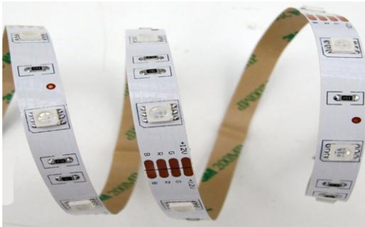
Striscia a led RGB fornita in bobine da 5 metri. Ideale per creare effetti di luce o per retroilluminazioni. Da installare sui nostri profili in alluminio o su superfici metalliche per dissipare il calore.
