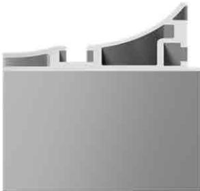
Profilo monofacciale per Lightbox in alluminio anodizzato argento. Spessore 60 mm. La grafica viene fissata sul fronte attraverso un gommino in silicone che garantisce una rapida installazione del tessuto alla cornice.
