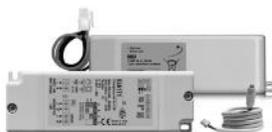
Il **kit di emergenza** consente, in caso di interruzione della corrente elettrica, di mantenere accesa la lampada LED per la **durata di almeno 1–3 ore** a seconda del modello, con una potenza inferiore allo standard. Il kit è composto da batterie Ni-Cd che garantiscono elevata capacità e durata. Tempo di ricarica di circa 12 ore.
