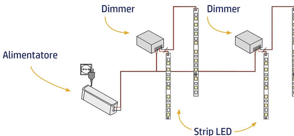
In funzione della potenza da gestire, può essere necessario abbinare ai dimmer e/o controller anche gli **amplificatori di segnale**.
