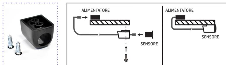
1. Per l' **installazione ad incasso** effettuare un primo foro di diametro 14 mm e profondità 2/3 mm e un secondo foro, interno al primo, di diametro 12 mm e profondità 18 mm
